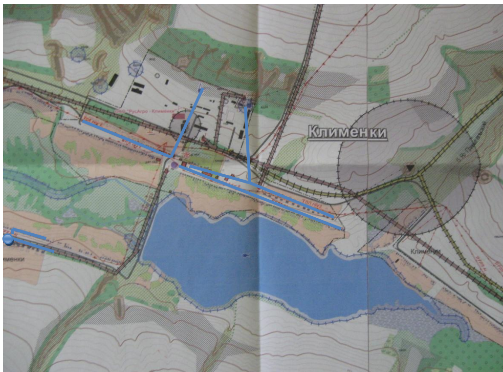
Рисунок 10. Схема существующей сети водоснабжения села Клименки.
